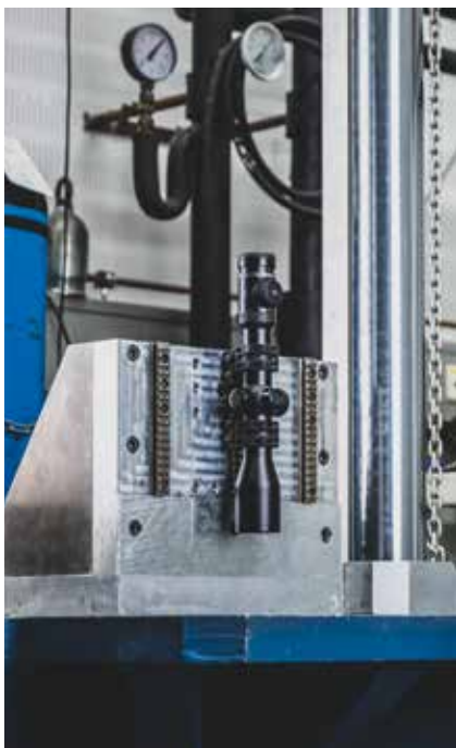
Das ZEISS Victory V8 bei der Schock-Simulation. Auch nach über 800 Schocks bleibt das Schussbild unverändert.
