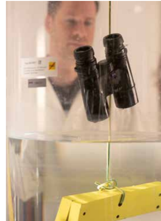
Mit allen Wassern gewaschen: Die Tests im Labor belegen, dass selbst Starkregen den Optiken nichts anhaben kann.
