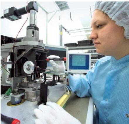
Abb. 2: Ca. 7000 sog. Stützstellen bedient sich der Computer bei der Justierung des Stereo Discovery.V20.
