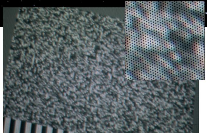
Segmento da imagem projetada, F35/NAVITAR HM117/11.7 – (imagem de teste) Definição: medíocre – pixels desfocados; dados de exposição: Canon EOS 5D Mk II, ZEISS Macro-Planar 2/100, ISO 800, f/2, 1/8s.
