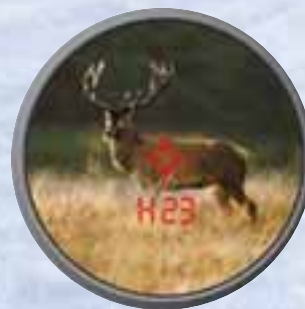
Nach der Anzeige der Entfernung erscheint H 23. Der Jäger muss 23 cm höher als Fleck halten.
