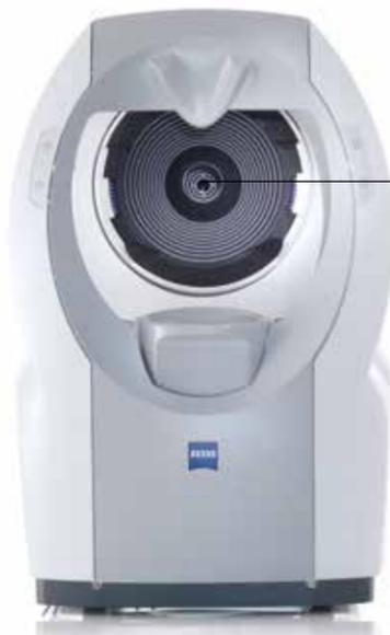
**Hochauflösender Hartmann-Shack-Wellenfrontsensor:** Das genaue Seh-Profil des Auges wird an 1.500 Punkten auf der 7 mm großen Pupillenöffnung ermittelt
