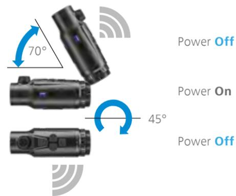
Der Winkelsensor erkennt automatisch die exakte Position des ZEISS DTC 3 und aktiviert den Standby-Modus bei 45° seitlicher Neigung sowie bei einer 70°-Neigung nach unten oder oben. Bringt man die Waffe wieder in den Anschlag, verlässt das Gerät automatisch den Standby-Modus.
