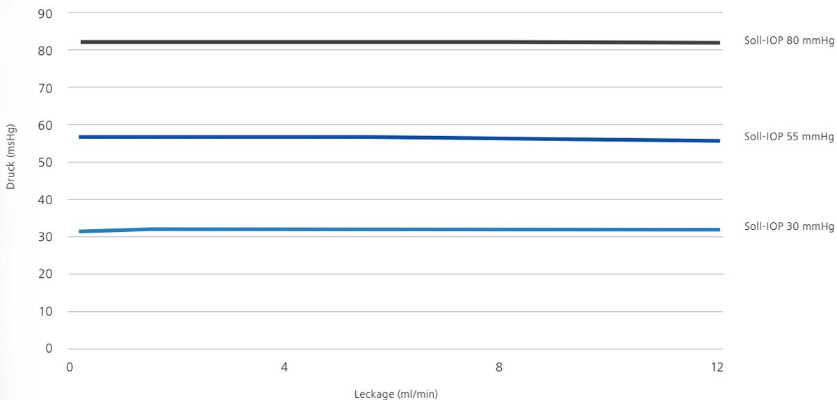
IOP-Stabilität mit Leckage auf Soll-IOP, bei Flow von 60 cc/min
