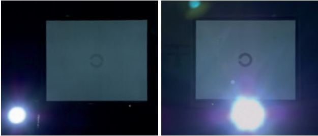
Abb. 10 Aufbau für Blendungstest mit Lichtquelle und Sehtafel/Sehzeichen [20]
