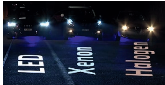
Abb. 8 Verschiedene Farbtemperaturen von LED-, HID-/Xenon- und Halogenscheinwerfern im direkten Vergleich (A)
